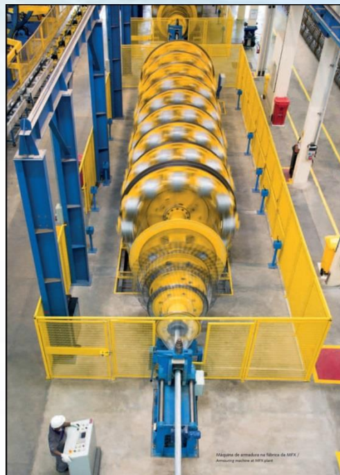
Fabricação da armadura
